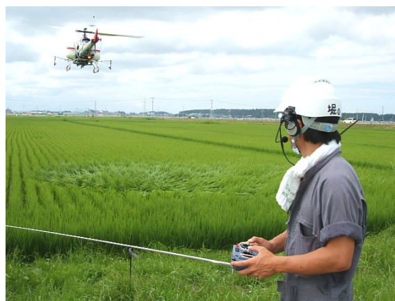
無人ヘリは高度2～3メートルの超低空を飛ぶため防除のための薬剤を効率よく散布できる
