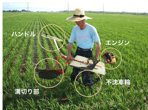
溝切り機 (作溝機)。後ろの三角形をした金属のフロートで田んぼに溝を掘っていきます
